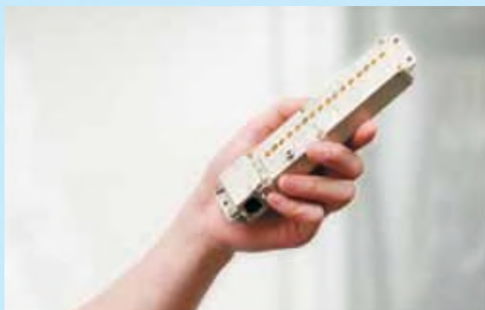
DirectDigital: миниатюрный блок электроники в катушке.
