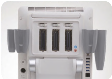
Три разъема для датчиков, доступных для выбора на экране
